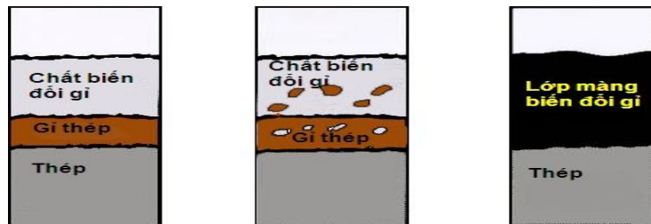
Hình 4. Quá trình biến đổi gỉ trên bề mặt thép
