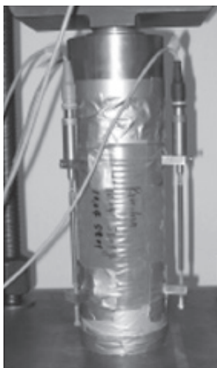
Hình 2.7b: Từ biến của UHPC mẫu có bao bọc
